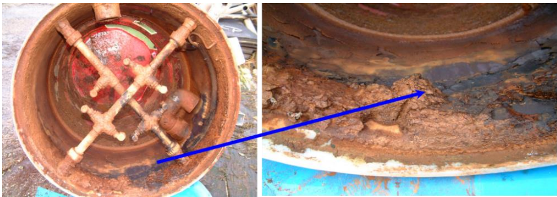
Figuur 24 Bacteriegroei (blauwe gloed) door een combinatie van veel lucht en ijzerneslag
